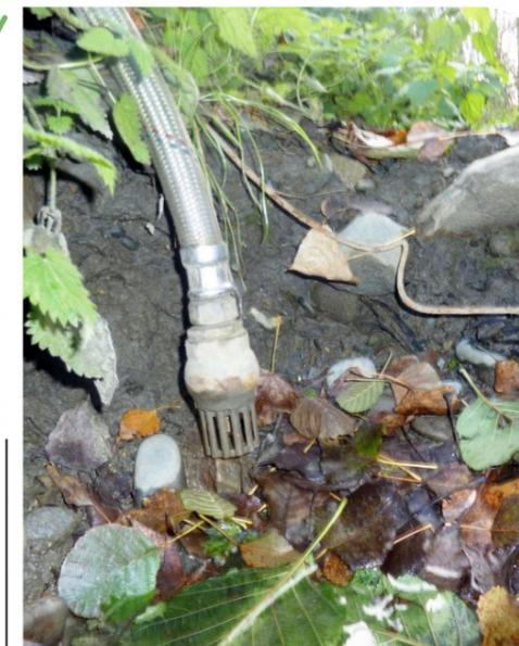
Exemple de crépines à mettre en place et conformes pour le Desman
